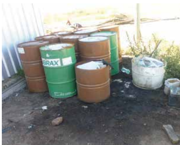
Figura 20: Almacenamiento incorrecto de aceites.
